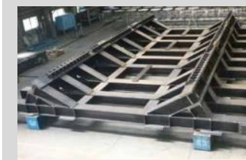
シールド架台
