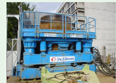
全回転オールケーシング工法
