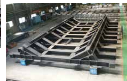
シールド架台
