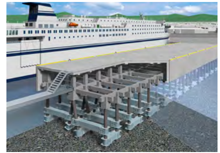
深梁工法 施工イメージ
