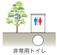
非常用トイレ
