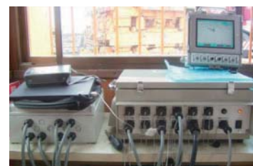
施工管理計の例
